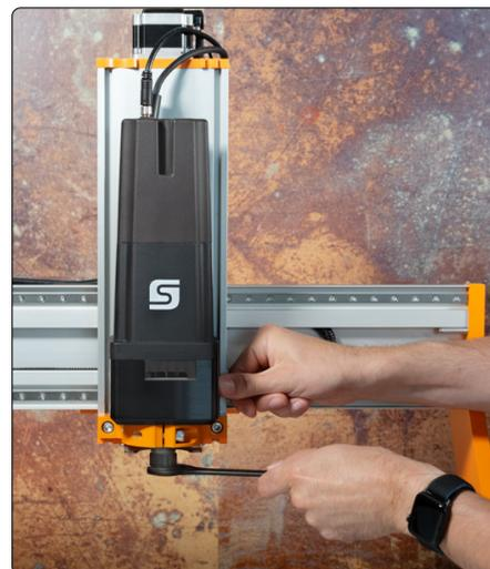
Werkzeug und setzen das Neue in die mittlere Öffnung der Spannmutter ein. Befestigen Sie das Werkzeug, indem Sie die Spannmutter fest anziehen (10 - 11 Nm), während Sie den Sperrdrücker betätigen. Wir empfehlen den Werkzeugwechsel nur an einem eingespannten Fräsmotor durchzuführen, um die Verletzungsgefahr zu minimieren. Wir empfehlen zudem Handschuhe zu tragen, wenn Sie ein Einsatzwerkzeug anfassen.
